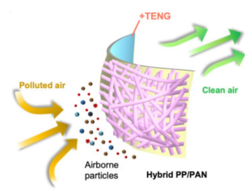
Figure 3 – Principe d'un masque triboélectrique pour la captation des particules fines [WBL21]
