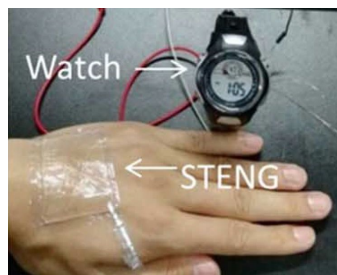
Figure 2 – Exemple d'un récupérateur d'énergie "double peau" triboélectrique [PLC17]
